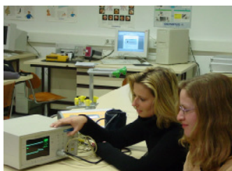
Abb. 1: Betrieb eines Sauerstoffkonzentrators am Trenntransformator zur Signalverfolgung und Überprüfung des Spülzyklus
