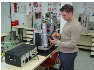
Abb. 1: Betrieb eines Sauerstoffkonzentrators am Trenntransformator zur Signalverfolgung und Überprüfung des Spülzyklus
